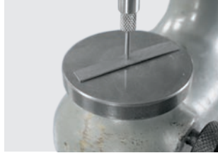
Mesure de la déformation: Après simulation des cycles de cuisson de la céramique
